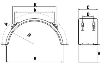
Wheelmate Pro Kotflügel mit vormontierten Halterungen 57 05 18 010 57 05 18 010 + internes Anti-Spray + Schmutzfänger
